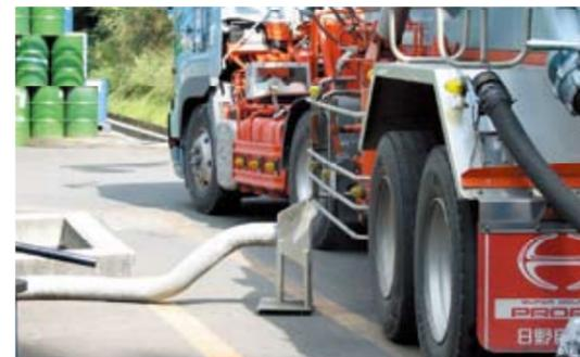
2004年11月の早朝に臭気の苦情があり、調査の結果、製品積み込み中の臭気が原因であると判りました。そこで、車両タンクの真空ポンプの排気ガスを従来の脱臭設備に引き込む装置を取り付け、テスト運転を開始しました。その後、クレームは無くなりました。
