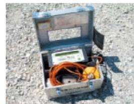
また、タンク清掃作業に使用しますガス検知器は、従来型は酸素と有機ガス濃度の2項目でしたが、新たに硫化水素と一酸化炭素濃度をプラスした検知ガス4項目のマルチ型に更新しました。
