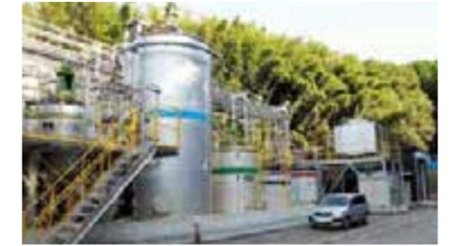
近隣工場などから受け入れた産業廃棄物をRF (Reclaiming Fuel/廃棄物を利用した再生燃料) に生まれ変わらせ、セメント工場に供給。CO<sub>2</sub>削減など環境負荷低減に貢献し、近年はアジアへも技術支援をしています。
