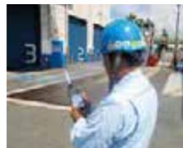
①臭気測定器による定時測定
