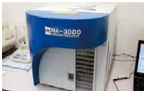
日本インスツルメンツ(株)製 加熱酸化水銀測定装置 MA-3000
